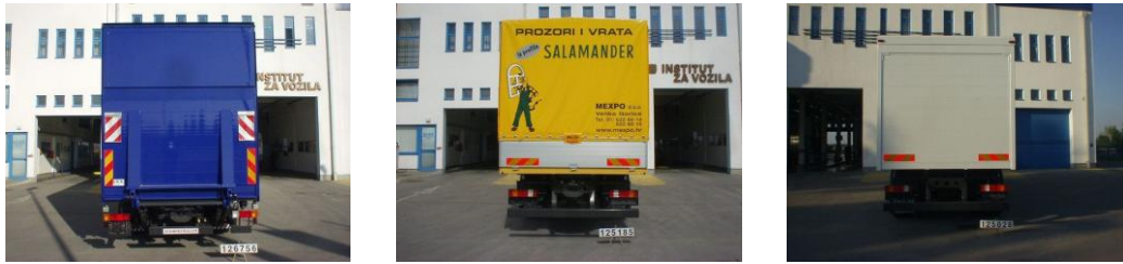
Slika 4. Primjeri ispravno postavljenih ploča za "teška" vozila
