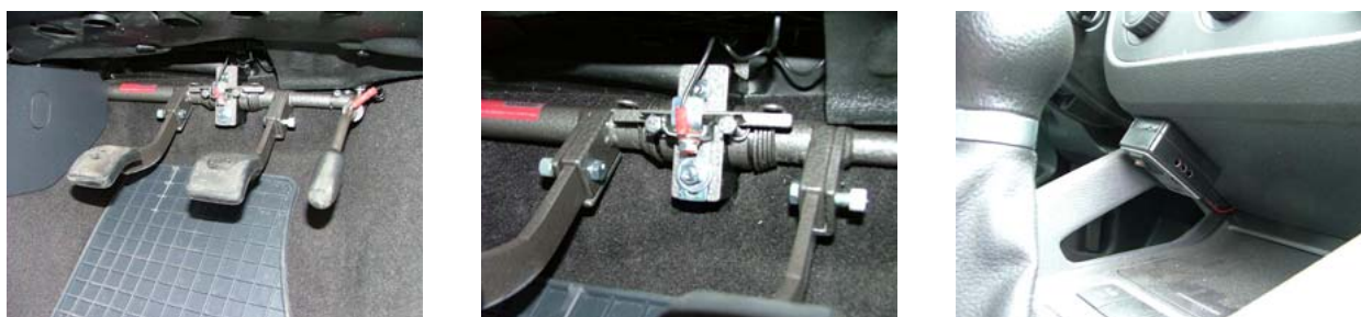
Slika 3. - Primjer ispravnog načina ugradnje zvučnih signala
