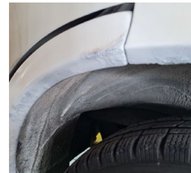
NEISPRAVNI POKUŠAJ SANACIJE KOROZIJE
