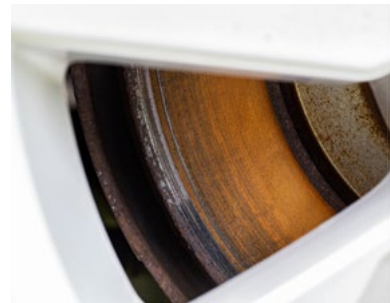
KOROZIJA NA DISKU
