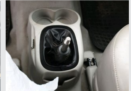
MEHANIČKO OŠTEĆENJE RUČICE MJENJAČA
