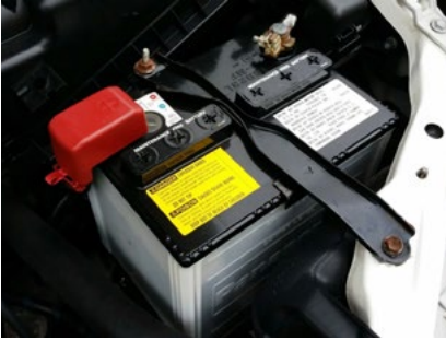
PROVJERA STANJA I UČVRŠĆENOSTI AKUMULATORA
