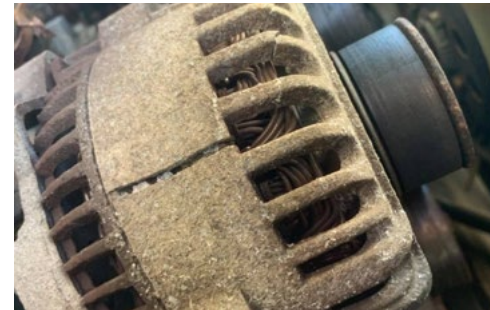
PRIMJER NEDOSTATKA: PUKNUTO KUĆIŠTE ALTERNATORA
