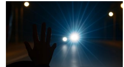
NEISPRAVNO PODEŠENA VISINA SVJETALA
